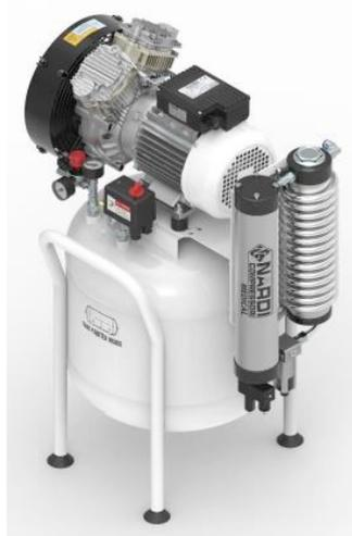
El compresor dispone de un motor monofásico con voltaje 230VAC 50Hz, potencia 2,5HP (1,85kW), absorción 13,5A, 1400rpm, con dos cabezales ligeros y compactos de fundición a presión de aluminio, equilibrados para minimizar las vibraciones, con un caudal máximo de 480lt. /min y presión máxima 10BAR.
