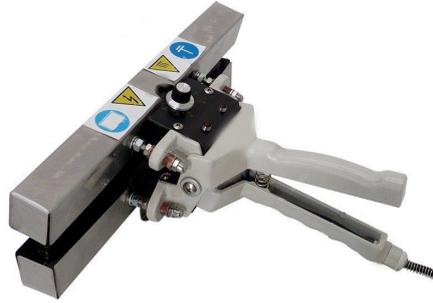
Pinza sencilla de utilizar que permiten soldar de forma rápida y sencilla. El mango ergonómico de material plástico aislante protege las manos del operador. Temperatura regulable hasta 250°C. Longitud de la junta de soldadura 300 mm, ancho 12 mm. Alimentación monofásica 230 V – 360 W – Peso 1,5 kg.
