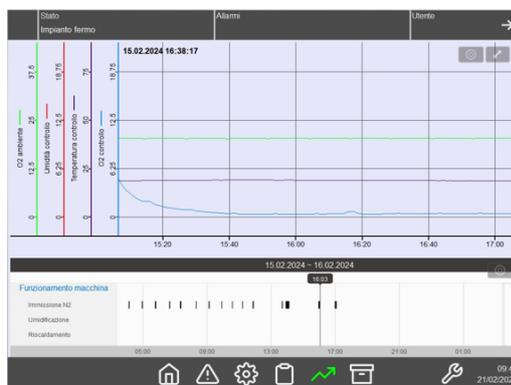
La interfaz gráfica está diseñada para conexión física con un cable a la red Ethernet del cliente o con un enrutador dedicado. Mediante la conexión a la red del cliente es posible visualizar y controlar la máquina a través de Internet, smartphone o un ordenador personal, y es posible recibir correos electrónicos con informes de alarmas o informes de datos en formato .CSV del procesamiento completado.
