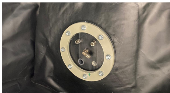
Vista de las conexiones al equipo exterior Anoxi24
